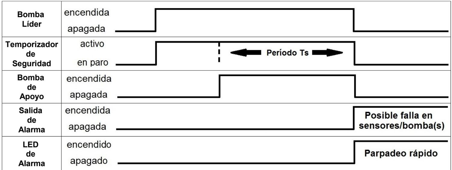
El periodo Ts se ajustará por medio del potenciómetro al frente del aparato, y su escala completa se definirá en los registros Modbus 1Eh y 1Fh.
