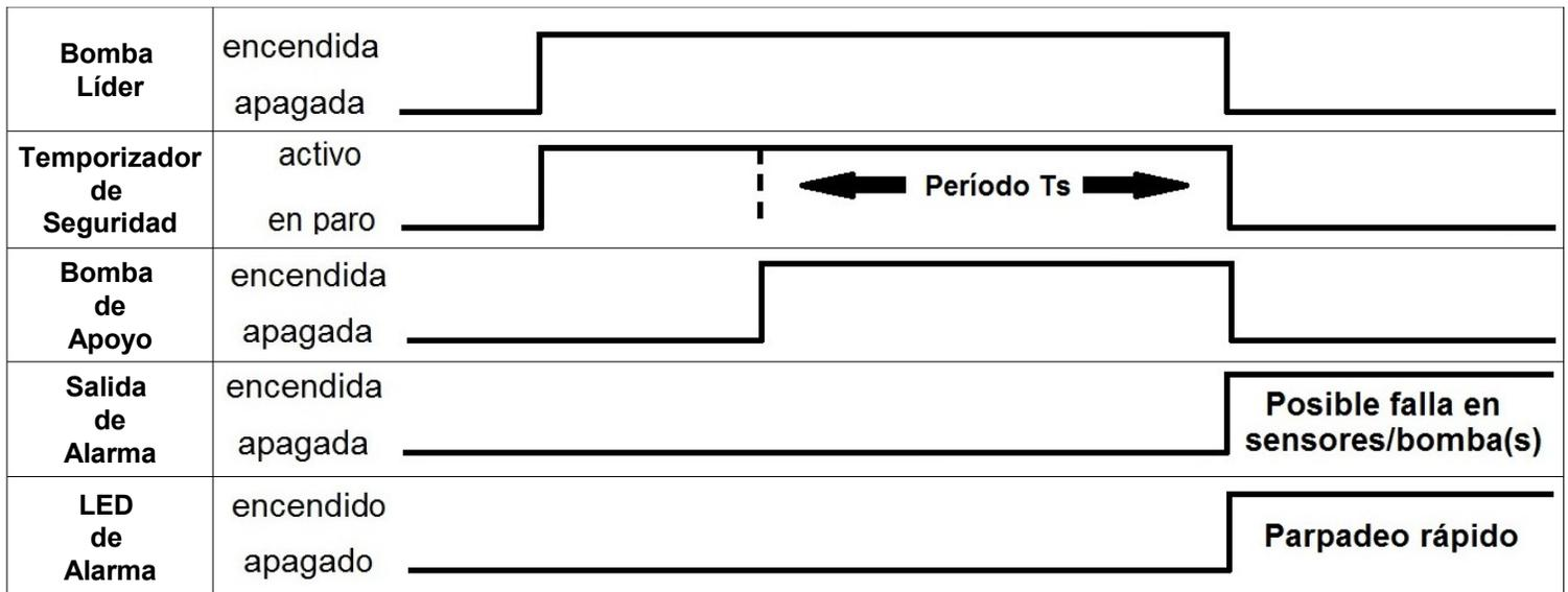
El periodo  $T_s$  se ajustará por medio del potenciómetro, y su escala completa se definirá en los registros Modbus 1Eh y 1Fh.
