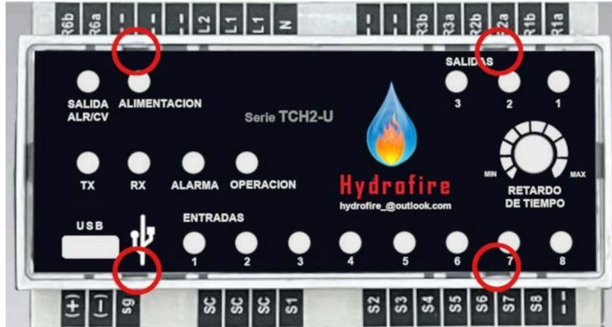
Para cerrar el aparato de nuevo, coloque la tapa en la posición que le corresponde, y presione ligeramente, hasta que escuche que los ganchos en las muescas han quedado atrapados en las cuatro posiciones.
