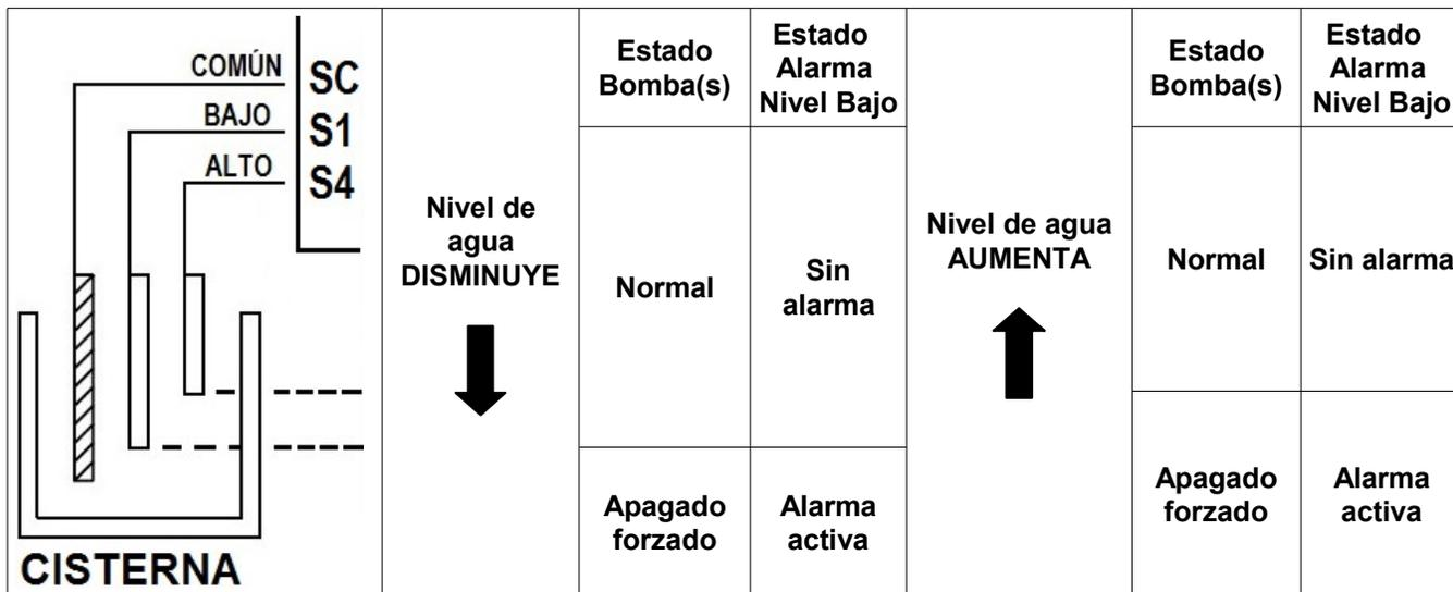
Según como se programen los retardos de tiempo, se puede seleccionar una operación símplex, con alternado de tres bombas (modo por defecto), u operación dúplex y alternado tríplex. El alternado se hará de la siguiente manera, siendo las bombas líder y de apoyo: 1 + 2, 2 + 3, y 3 + 1.
