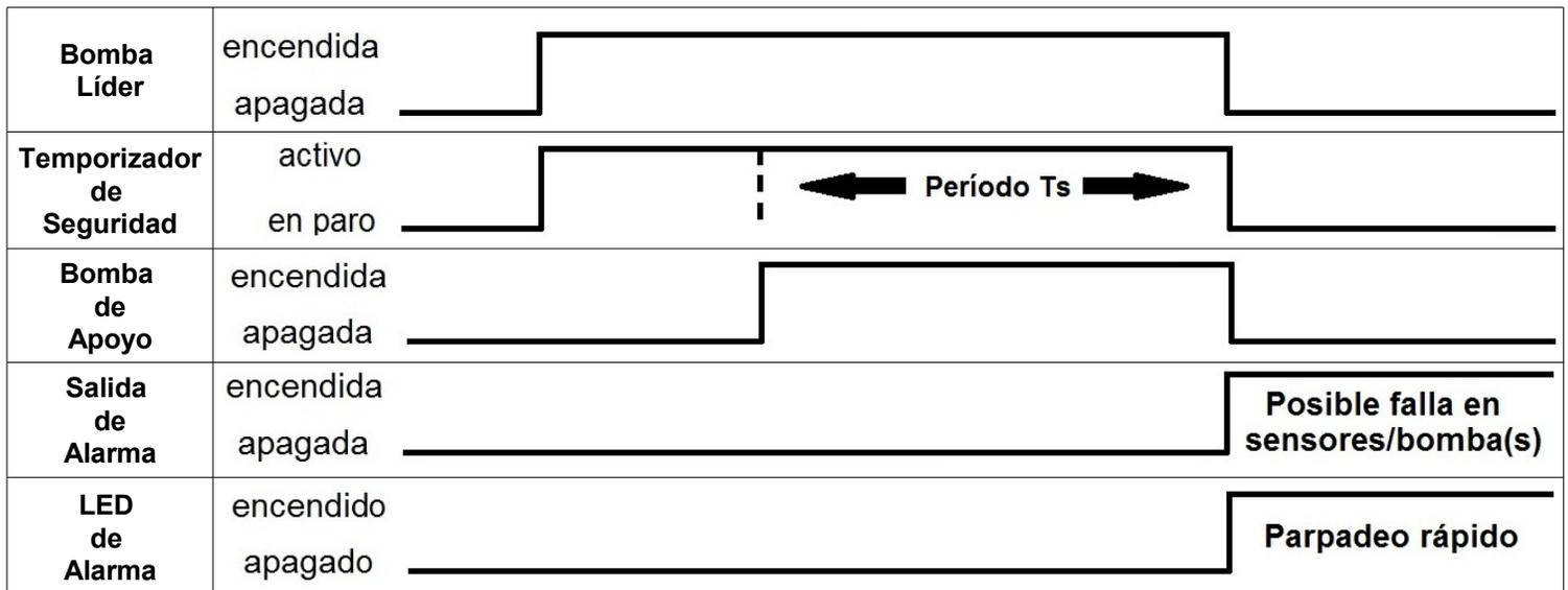
El periodo  $T_s$  estará predefinido en los modelos sin comunicación y sin potenciómetro. Para los modelos TCH2-U/TCH2-R, este periodo se ajustará por medio del potenciómetro, y su escala completa se definirá en los registros Modbus 1Eh y 1Fh.
